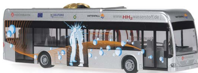
MERCEDES-BENZ Citaro CellBus „Hochbahn, Hamburg“ Die Brennstoffzellen, der Druckgasbehälter und die Kühler sind komplett hinter einer Verkleidung auf dem verstärkten Dach verstaub. Im Heck befinden sich ein Elektromotor mit 200 kW Antriebsleistung und das Sechsgang-Automatikgetriebe. Die Hamburger Hochbahn gehörte zu den zehn ersten Verkehrs-betrieben europaweit, die diese Technologie im harten Alltagsinsatz testen durften.
