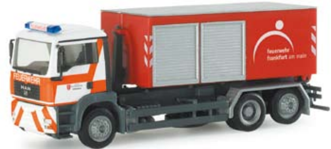
047777 | MAN TGA M WLF "Feuerwehr Frankfurt" Wechselladerfahrzeug der Berufsfeuerwehr Frankfurt am Main Interchangeable loading system vehicle of the municipal fire brigade Frankfurt am Main
